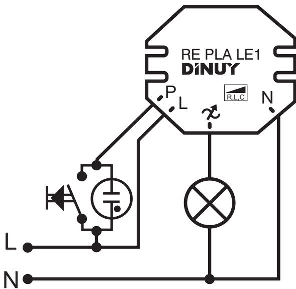
Ejemplo de sustitución de una instalación conmutada por una instalación con regulador y pulsadores
