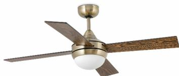
Ventilador de techo con luz de líneas modernas ideal para estancias de menos de 13m<sup>2</sup>. Palas reversibles. Accionado por mando a distancia, incluido. Dispone de 3 velocidades regulables con un consumo de 16 - 24 - 35W y 135 - 175 - 210 revoluciones por minuto según velocidad. Este ventilador dispone de función inversa. Caudal de aire: 101,09 m<sup>3</sup> min / 3568 CFM. Apto para techo inclinado.
