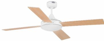
Ventilador de techo de estilo clásico ideal para habitaciones a partir de 17,6m<sup>2</sup>. Motor fabricado en acero y palas de madera plywood. El acabado de las palas es blanco y arce reversibles. Accionado por mando a distancia, incluido. Dispone de 3 velocidades regulables con un consumo de 14 - 32 - 59W y 100 - 152 - 203 revoluciones por minuto según velocidad. Este ventilador es de fácil instalación. Dispone de función inversa. Este ventilador es apto para techo inclinado.
