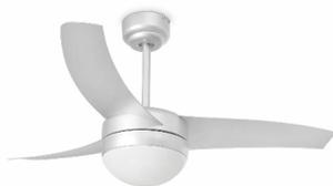
Ventilador de techo moderno con luz ideal para habitaciones de hasta 13m<sup>2</sup>. Motor fabricado en acero, palas en ABS y difusor de cristal opal. El acabado de las palas es blanco y son no reversibles. Accionado por mando a distancia, incluido. Dispone de 3 velocidades regulables con un consumo de 10,7 - 23,5 - 68,1w y 105 - 185 - 285 revoluciones por minuto según velocidad. Este ventilador dispone de función inversa. Este ventilador es apto para techo inclinado.
