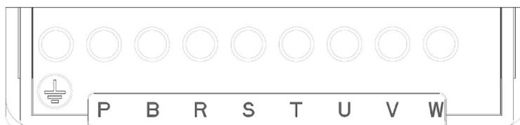
**Figura 3-5-2 Terminales de potencia
