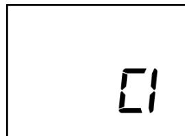
Para modificar los parámetros, acceda con la tecla **OK/Mode** al valor del parámetro, modifique el valor con las teclas +/- y confirme el valor del parámetro con la tecla **OK/Mode**.
