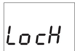
Para desbloquear el teclado, presionar las teclas “+” y “-” simultáneamente durante 3 segundos.
