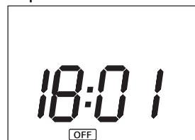
**3.6.2.** Si el emisor se apaga utilizando el interruptor general de la parte trasera o se desconecta de la red de suministro eléctrico y no se encuentra asociado a una centralita Wifi G Control Hub, la configuración horaria se elimina.
